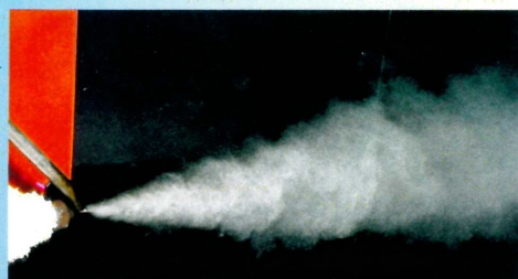
Диспергирование жидкого топлива струей перегретого водяного пара
